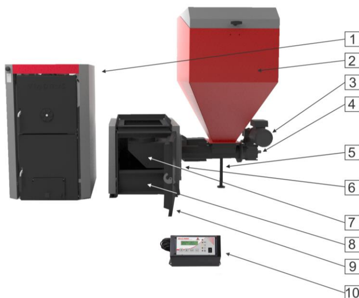
Rys. 16. Opis kotła oraz zestawu palnika automatycznego retortowego/rynnowego.
