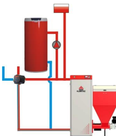
Obr. číslo 12. Ohřívací systém v režimu LÉTO – pouze teplá užitková voda
