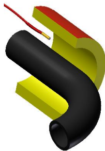
Obrázek číslo 3 Montáž čidel teploty
