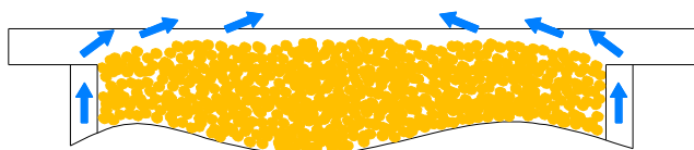
Obrázek číslo 9. Umístění pelet vůči roštu retortového hořáku v průběhu provozu kotle.
