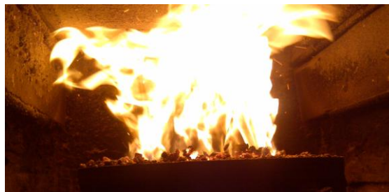
Obrázek číslo 9. Umístění pelet vůči roštu retortového hořáku v průběhu provozu kotle.
