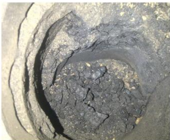
Obrázek číslo 14 Zbytky po spalování (spečence), které vznikly v průběhu spalování pelet – pohled na koleno retorty shora.
