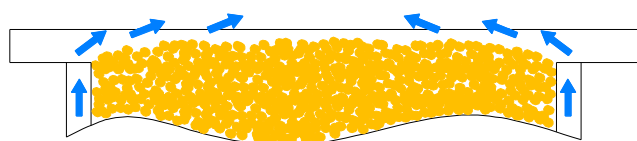
Obrázek číslo 9. Umístění pelet vůči roštu retortového hořáku v průběhu provozu kotle.
