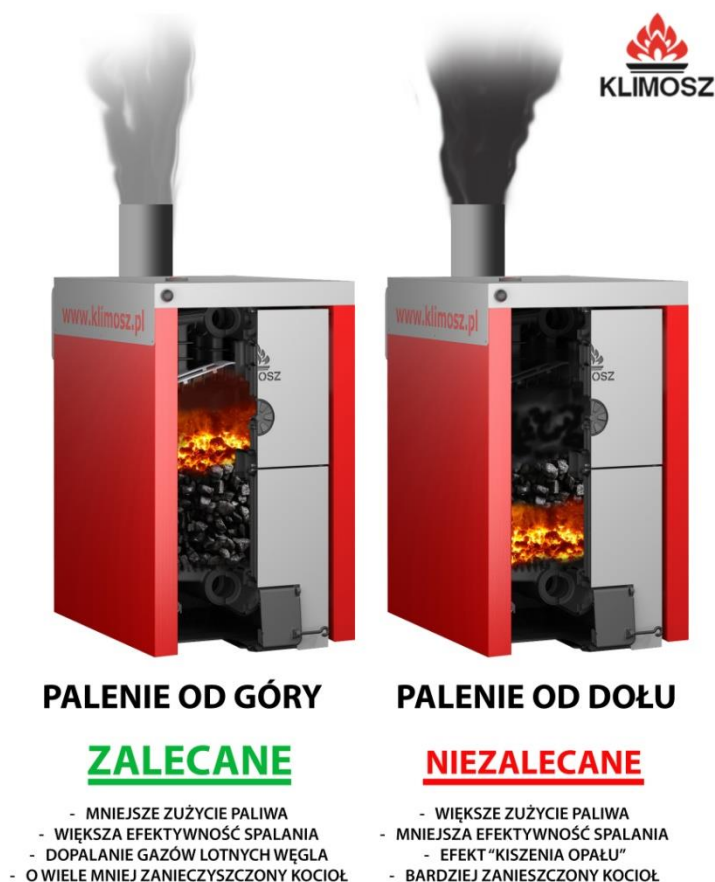
Rys.13. Schemat palenia od góry i od dołu.
