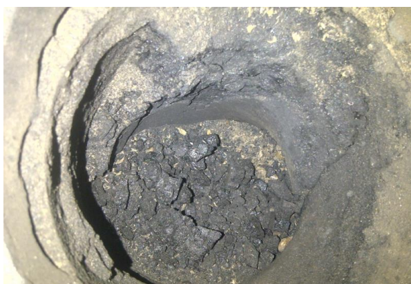
Rys. 14. Nagar powstały podczas spalania pelet – widok kolana retorty z góry.
