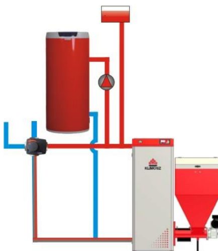
Rys. 12. Układ ogrzewania w trybie LATO – tylko c.w.u.
